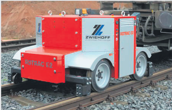
Pilt 1: Muljetavaldavalt väike: Rotrac E2 on ehitatud äärmiselt kom- paktsena ning suudab ohutult vedada 250-tonniseid koormaid. Innova- tiivne ajami kontseptsioon tagab alati vajaliku pinnasurve rööbastele.
